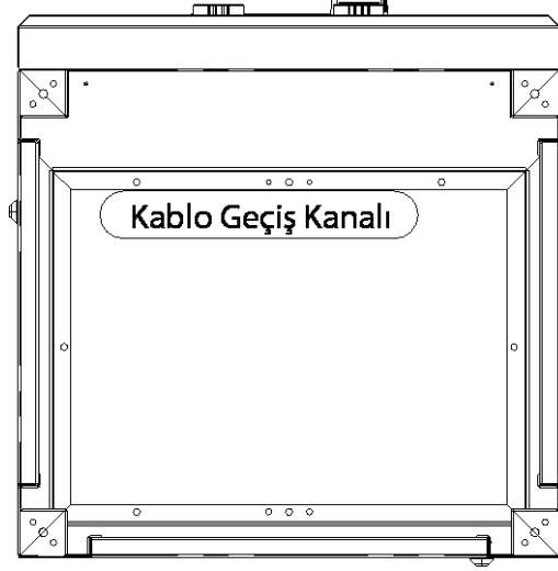
Şekil 8 Şarj İstasyonu Kablo Geçiş Kanalları
